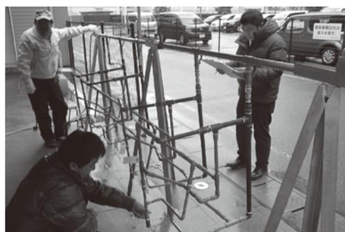
水圧による漏水検査
