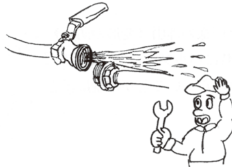
ツーピース形ボール弁の胴着もれトラブル事例 8)
