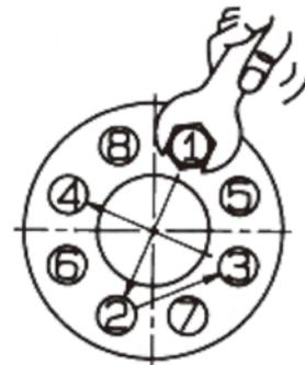
フランジのボルト締め付けは、タイヤ交換のように相対交互に仮締めしてから順繰りに本締めする
