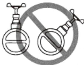
このバルブは止め弁でなく逆止め弁でハンドルは「バイパス用内蔵弁」だからハンドル位置は横向きが正しいよ!
