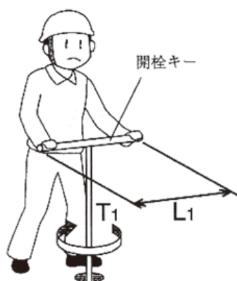
開栓キーによるバルブ開閉操作とキャップの表示例 〈出典：水道用バルブ便覧〉
